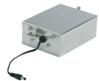
取り外された電池ボックス
