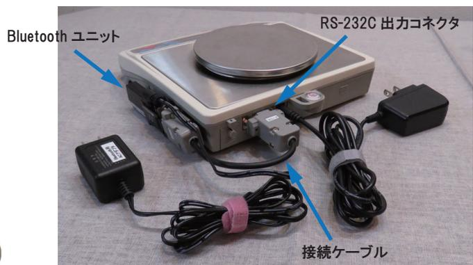
※ RS-232C 出力のコネクタは、メーカーにより D-Sub や DIN のタイプが使用されており、ピンの信号出力も統一されないので、Bluetooth ユニットを接続するには、専用のケーブルが必要です。shopkinos では、専用の接続ケーブルを用意しております。
