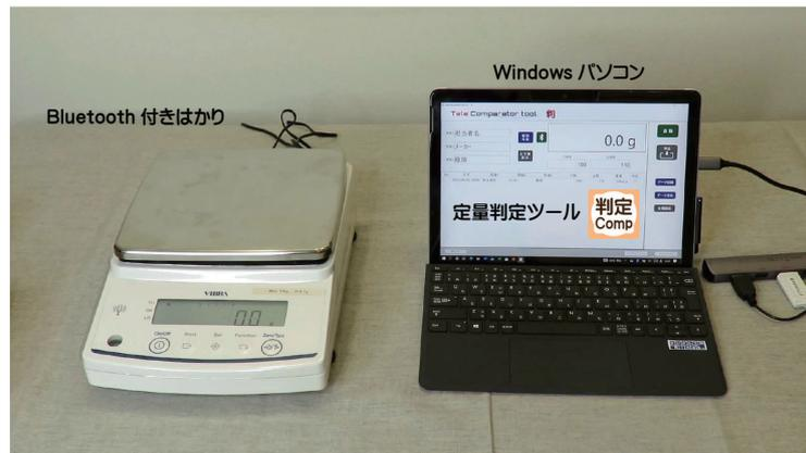
定量判定ツールのソフトとしては、「Tele Comparator Tool 判」を使用します。計量物の重量が上下限範囲内か判定し、判定結果を大きな画面で表示し、同時に判定結果のデータを記録します。加工品の重量や包装物の適正量などのチェックに最適なソフトです。
