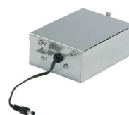
取り外された電池ボックス
